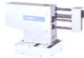
Fig. 4 Robot pick&place, destinat operațiilor de asamblare de mare viteză
